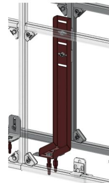
F - Опора для отдельностоящей перегородки ХОММЕТ9030017
