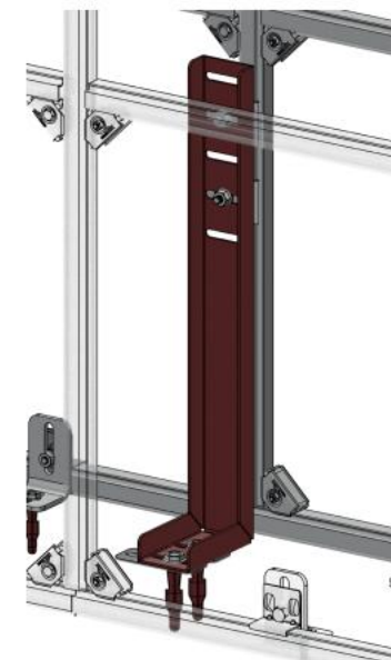
F - Опора для отдельностоящей перегородки ХОММЕТ9030017
