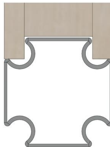
прилегание к вертикальным стойкам каркаса
